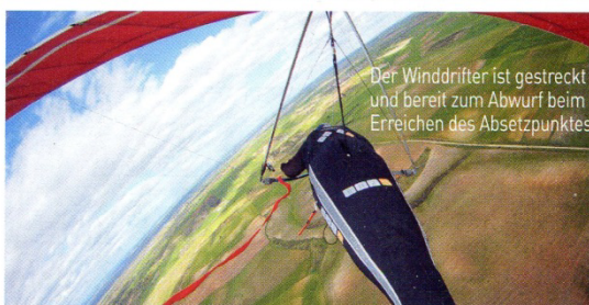
Winddrifter griffbereit an der Basis befestigt. So positioniert, verlangt die Anwendung ein Minimum an Konzentration und Koordination.
